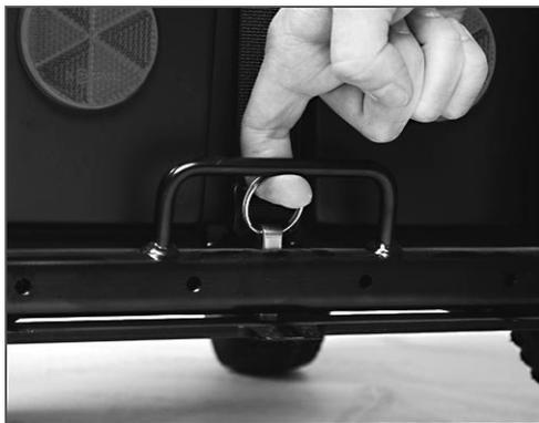
Fig. 28 Perno de desbloqueo del cajón de las baterías
