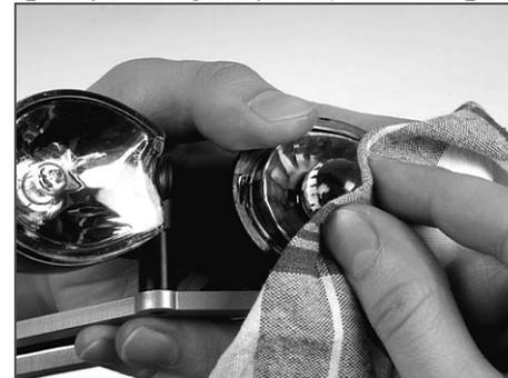
**Fig. 26 Sustitución de las luces intermitentes**
