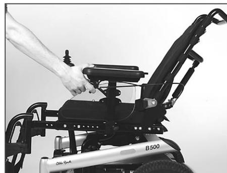
Fig. 21 Ajuste mecánico del ángulo del respaldo
