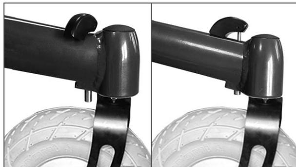
Fig. 29 Bloqueo y desbloqueo de la dirección
