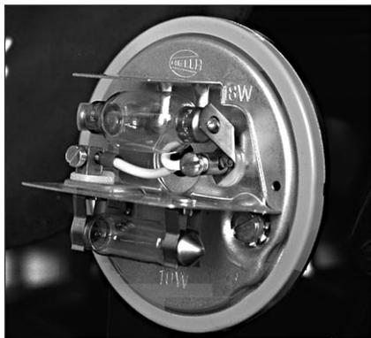
**Fig. 27 Luces traseras sin revestimiento**
