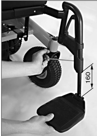
Fig. 10 Ajuste del reposapiés a la longitud de las piernas
