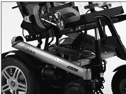
Fig. 20 Inclinación eléctrica del asiento
