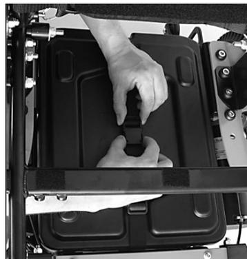
**Fig. 17 Cierre a presión de la correa de sujeción**
