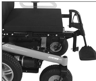
Fig. 12 Desmontaje del reposapiés
