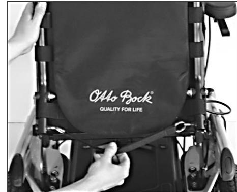
Fig. 5 Correa de desbloqueo del respaldo
