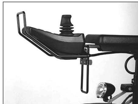
Fig. 31 Soporte del panel de control con altura ajustable
