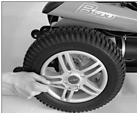
**Fig. 38 Desmontaje de la rueda de accionamiento**
