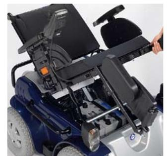
La unidad de asiento bascula para un control fácil y rápido de los fusibles y de las baterías.
