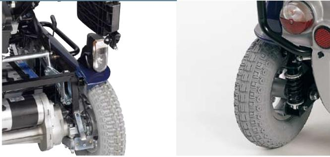
Suspensiones traseras y delanteras ajustables Para un confort óptimo y una buena amortiguación de los impactos.
